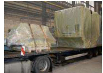
工作機械の防錆（保管・輸出時）
