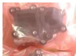
アルミ材と鉄材の 組み合わせた部品の防錆
